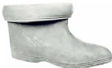
Диэлектрические боты предназначены для дополнительной защиты от электрического тока при работе на закрытых, а при отсутствии осадков — на открытых электроустановках при напряжении свыше 1 кВт. Изделие полностью сохраняет свойства при температуре от -30°C до +50°C
