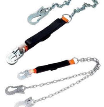
Строп из металлической цепи  $\varnothing 6$  мм с амортизатором используется как отдельная соединительная деталь, узел или компонент в системе с привязями и с анкерной точкой. Наличие амортизатора позволяет компенсировать травмоопасные динамические нагрузки на работающего при падении с высоты.
