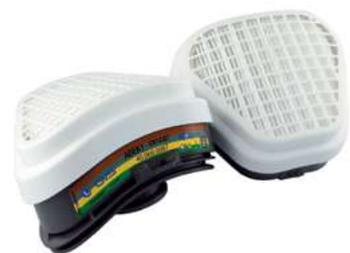
Защита от органических газов и паров с температурой кипения выше 65°C, неорганических, кислых газов и паров, аммиака и аэрозолей. Технология HESPA. Фильтры с активированным углем.
