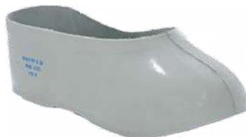
Галоши диэлектрические являются дополнительным средством защиты от поражения электрическим током при работе в закрытых электроустановках, а также в открытых при отсутствии дождя и мокрого снега. Галоши разрешается применять при напряжении до 1 кВ и температуре от -30°C до +50°C
