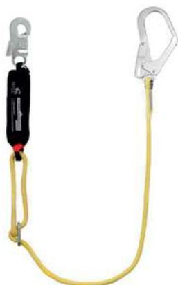
Строп одинарный, регулируемый, с амортизатором. Огнеупорный строп изготовлен из текстильного каната с оплеткой из арамидного волокна диаметром 11 мм. Стропы огнеупорные применяют при выполнении электрогазосварочных и других работ, проводимых в непосредственной близости от огня. В составе стропов имеются соединительные элементы, вшитые неразъемным способом.
