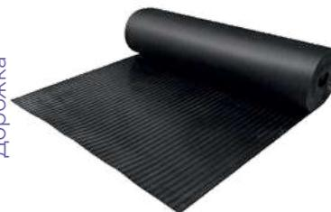
Дорожки диэлектрические применяются в качестве дополнительной защиты в закрытых электроустановках напряжением 1000 В и более, кроме особо сырых помещений, а также в открытых электроустановках в сухую погоду. Имеют продольную рифленую однотонную лицевую поверхность. Выдерживают напряжение 20 кВ переменного тока частотой 50 Гц. Температура среды для эксплуатации: от -15°C до +40°C.
