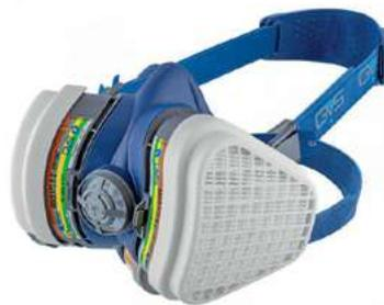
Материал корпуса из мягкого гипоаллергенного термopластичного эластомера, не содержит силикона и латекса. Защита от органических газов и паров с температурой кипения выше 65°C, неорганических, кислых газов и паров, аммиака и аэрозолей.
