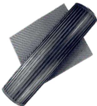
Ковры диэлектрические применяются в качестве дополнительной защиты в закрытых электроустановках напряжением 1000 В и более, кроме особо сырых помещений, а также в открытых электроустановках в сухую погоду
