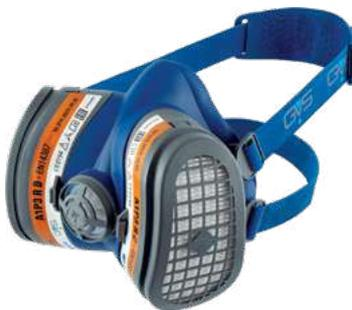
Материал корпуса из мягкого гипоаллергенного термopластичного эластомера, не содержит силикона и латекса. Защита от органических газов и паров с температурой кипения выше 65°C, от пыли, дыма, тумана, микроорганизмов.
