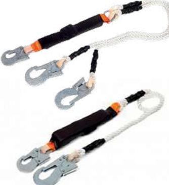
Строп из полиамидного каната  $\varnothing 13$  мм с амортизатором используется как отдельная соединительная деталь, узел или компонент в системе с привязями и с анкерной точкой. Наличие амортизатора позволяет компенсировать травмоопасные динамические нагрузки на работающего при падении с высоты.
